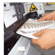
Mise en place manuelle de la liasse pré-perforée et sertissage automatique.
