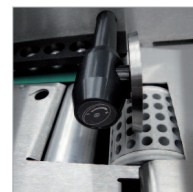
Dispositif de prise papier à succion par le bas.
