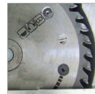
Grecquage et fraisage de la tranche des documents pour une meilleure pénétration de la colle.
