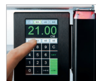
Écran de commande tactile pour le réglage de la butée arrière.
