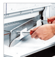
Dispositifs sécurisés pour le changement de la lame et de la réglette.
