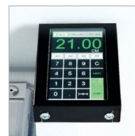
Écran de commande tactile pour le réglage de la butée arrière.
