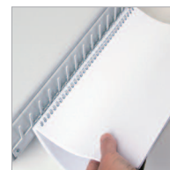
Peigne de positionnement de l'élément de reliure (ci-dessus) et molette d'ajustement du système de pression (ci-dessous).
