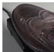
Perforation électrique déclenchée par pédale.
