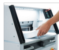
Barrage immatériel par cellules photo-électriques (IDEAL 4860).
