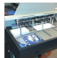
Plateau haute pile pour l'alimentation automatique des couvertures.
