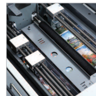
Découpe transversale par massicot et longitudinale par outils circulaires.
