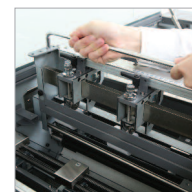
Perforation longitudinale complète, partielle ou séquentielle.
